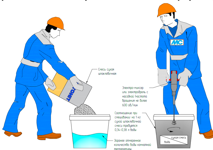
Рис. 1. Организация работ по затворению сухой шпаклевочной смеси
